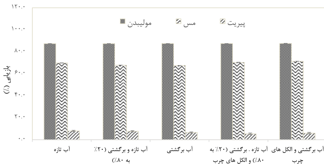
شکل (۲) نمودار میله‌ای مقادیر متوسط بازیابی مس، پیریت و مولیبدن تحت شرایط نمونه‌های مختلف آب
