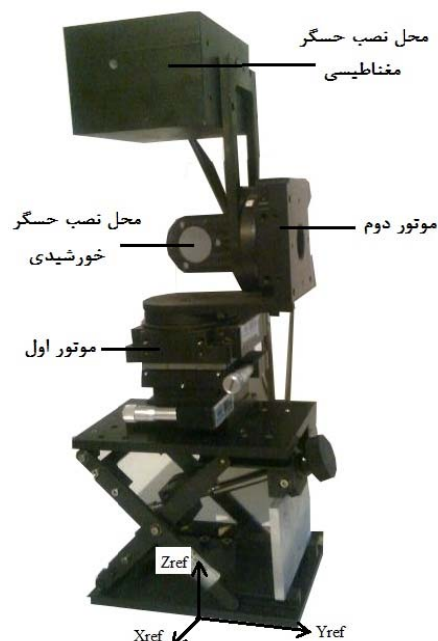
شکل ۲- مکانیزم حرکت‌دهنده حسگرها با دو درجه آزادی چرخشی
