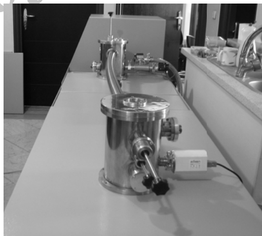
شکل ۱۰- تصویری از بدنه اصلی سیستم تولید باریکه پوزیترون حرارتی
