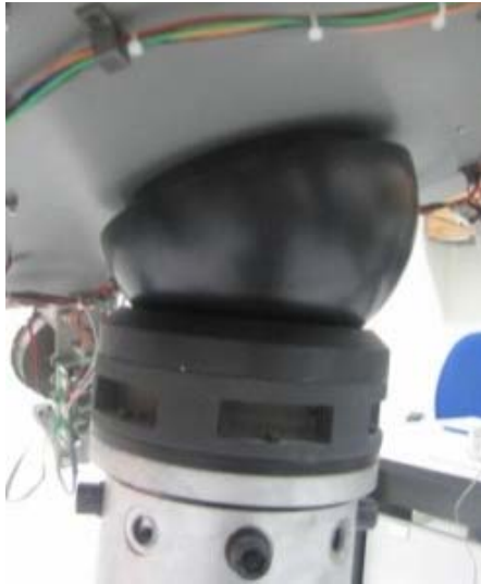
شکل ۸- تصویر یاتاقان هوایی نیم‌مکروی شبیه‌ساز در مجتمع دانشگاهی هوافضا
