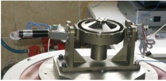
شکل ۱۲- تصویر یکی از عملگرهای مورد استفاده در شبیه‌ساز
