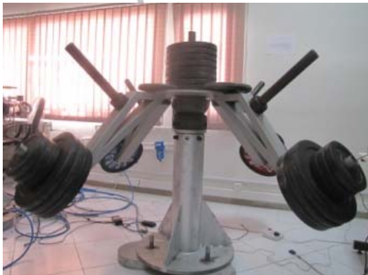
شکل ۹- تست وزنی و میزان مصرف در یاتاقان هوایی
