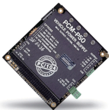
شکل ۲۴- مبدل تغذیه ولتاژ مستقیم به مستقیم P50
