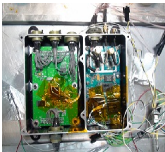
شکل ۳- جانمایی برد پردازشگر ODS (چپ) و گیرنده فضایی GPS (راست) در باکس زیرسیستم تعیین موقعیت ماهواره تدبیر
