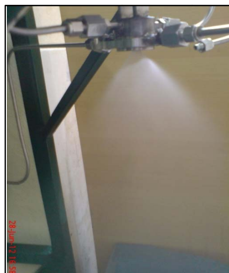
شکل ۶- آزمایش سرد مجموعه پاشش میکروموتور
