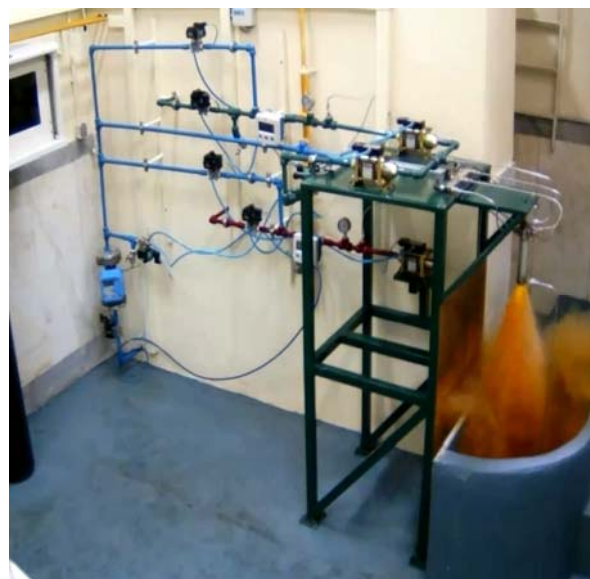
شکل ۱۲- آزمایش گرم میکرو موتور
