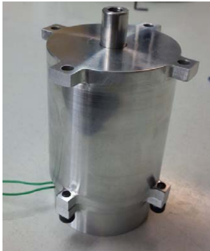
شکل ۱۸- نمونهٔ مونتاژشدهٔ پین پولر در سطح مهندسی
