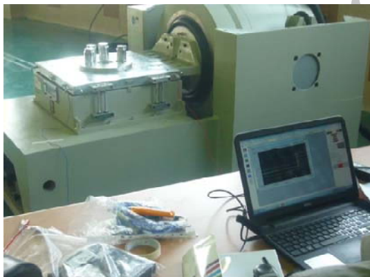
شکل ۱۹- اتصال پین پولرها به لرزاننده
