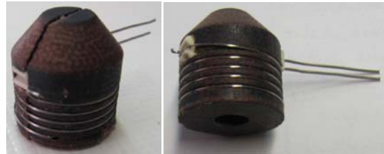
شکل ۳۷- نمای کلی قرقره مونتاژشده با سیم اتصال و سیم پیچشی
