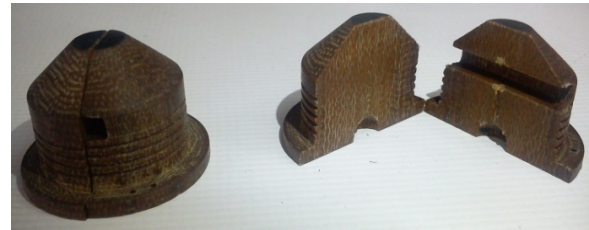
شکل ۱۶- قرقره‌های ساخته‌شده از فیبر استخوانی
