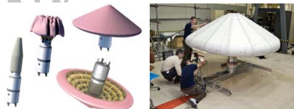
شکل ۴۰- سپر حرارتی بادشونده (ناسا-۲۰۱۴) [۶۹]
