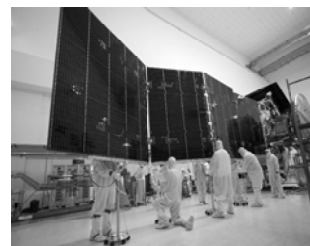
شکل ۲۱- مکانیزم بازکننده پنل سلول‌های خورشیدی با سطح صلب [۳۹]
