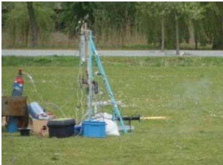
شکل ۳- تست میکروموتور سوخت مایع در دانشگاه دلفت هلند [۱۰]
