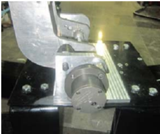
شکل ۳- مجموعه فنر محرک و میراکننده دورانی
