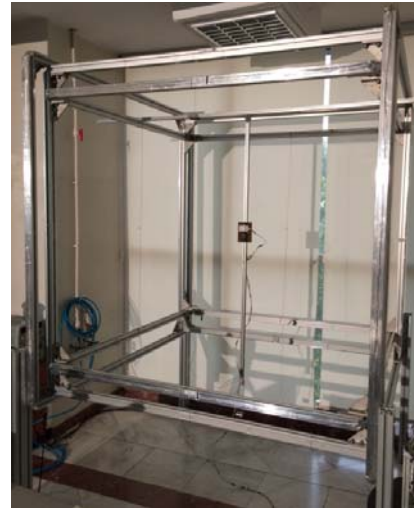
شکل ۷- بستر آزمون یکنواختی میدان مغناطیسی
