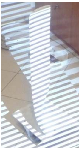
شکل ۶- پره روتور فن محوری در زمان داده برداری نوری به منظور مشخص شدن مدل دقیق هندسی
