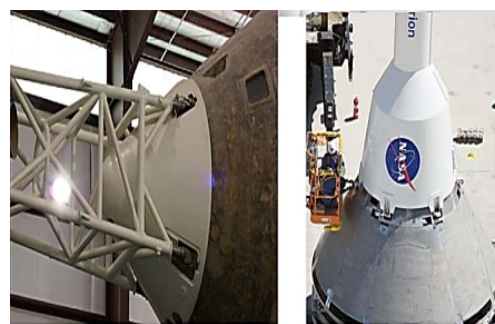
شکل ۲- نحوه اتصال سامانه لغو پرتاب به فضایی‌ها در فضایی‌های آپولو (سمت چپ) و اورایون (سمت راست)
