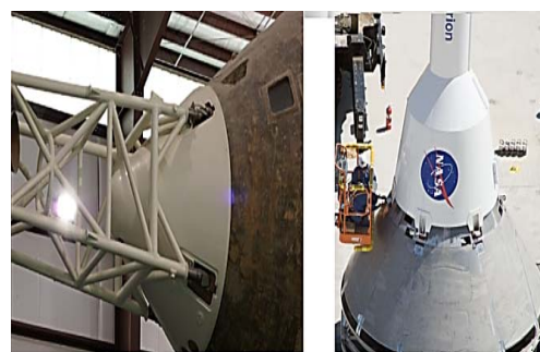
شکل ۲- نحوه اتصال سامانه لغو پرتاب به فضایی‌ها در فضایی آپولو (سمت چپ) و اورایون (سمت راست)
