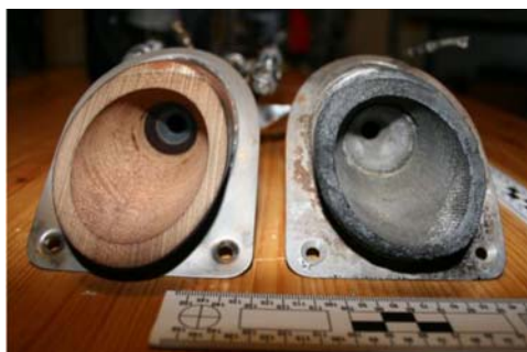
شکل ۱- الف) پروفیل نرخ انتقال حرارت در نازل (ب) مقایسه نازل سیلیکافنولیک قبل و بعد از پرواز [۱۰].
