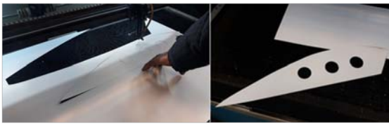
شکل ۱۳- برش لیزر شابلون ایرفویل دارای Cross point
