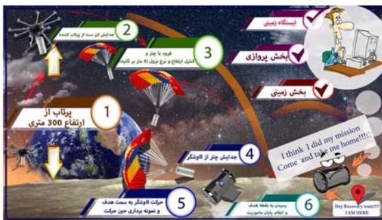
شکل ۱- پروفیل مأموریتی کنست آرتا
