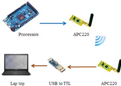
شکل ۲۱- نمایش شماتیک از ایستگاه زمینی
