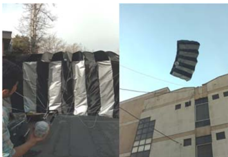
شکل ۱۸- تست پرواز (راست) و بادشدهی چتر (چپ)
