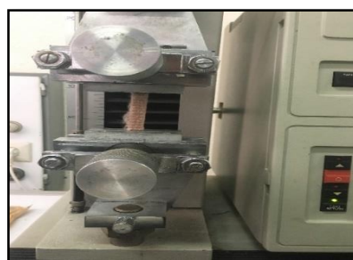
شکل ۴. دستگاه Micro50 و نحوه کشش مسلح کننده مورد استفاده در این پژوهش
