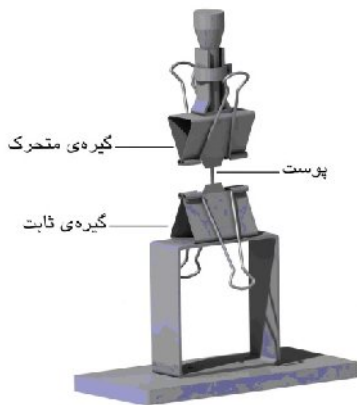
شکل ۳ گیره‌های مخصوص کشش پوست متناسب با دستگاه آنالایزر بافت.
