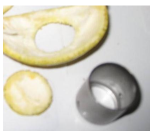
شکل ۳. برش پوست برای تعیین جرم حجمی پوست
