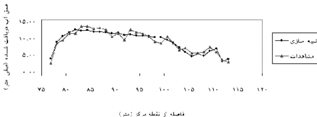
شکل 6- مقایسه مشاهدات و نتایج حاصل از مدل برای اسپری نازل نلسون R3000، ارتفاع استقرار 180 سانتی متر، تنظیم کننده فشار 138 کیلو پاسکال و ردیف ظروف جمع آوری Z در زیر اسپن سوم
