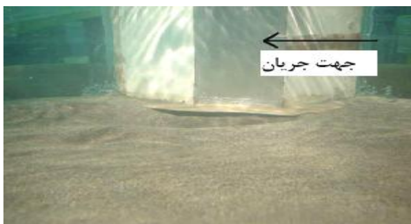
شکل 11- تصویری از شیار ایجاد شده در اطراف آبشکن طوق‌دار در تحقیق حاضر
