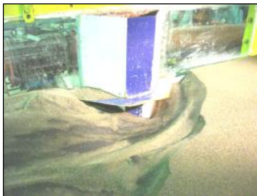
شکل 7- نمونه‌ای از حفره آبشستگی ایجاد شده در اطراف آبشکن طوق‌دار در تحقیق حاضر
