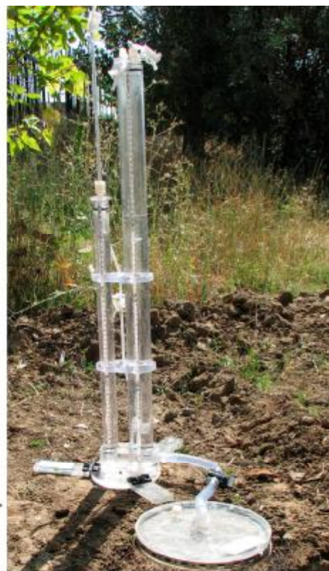
شکل 2- دستگاه نفوذسنج مکشی، الف) دستگاه استفاده شده در این پژوهش و ب) نمای شماتیکی آن (Soil Measurement Systems LLC, Tucson, Arizona)
