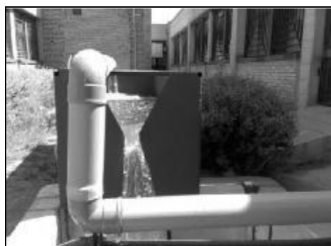
ب) سرریز مثلثی 53 درجه اندازه‌گیری دبی جریان
