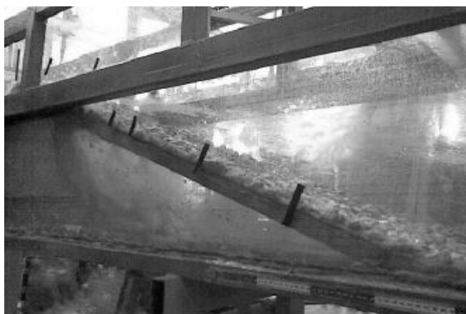
شکل 4- مدل آزمایشگاهی تندآب با بستر زبر.
