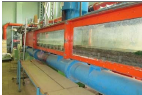
شکل ۱- فلوم آزمایشگاهی و بستر رسوبی.
