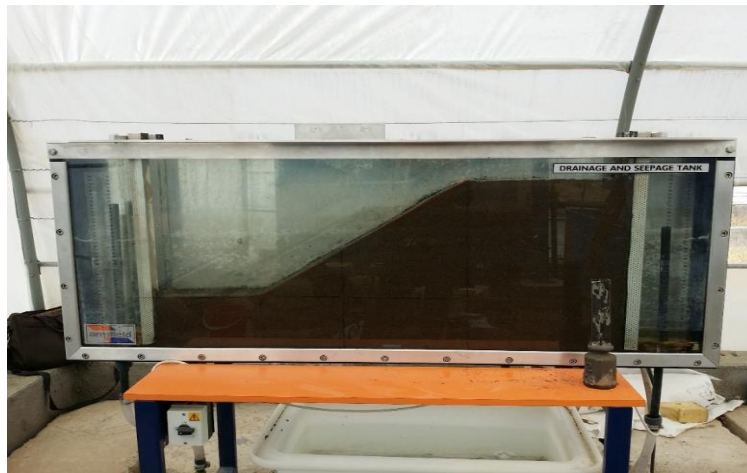
شکل ۱- نمایی از مدل فیزیکی تانک نشست و شیروانی خاکی.
