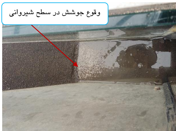
شکل ۵- شیروانی خاکی بعد از وقوع جوشش.
