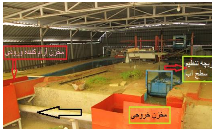
شکل ۲- نمایی از مدل فیزیکی قوس جنکيه همراه با متعلقات آن.
