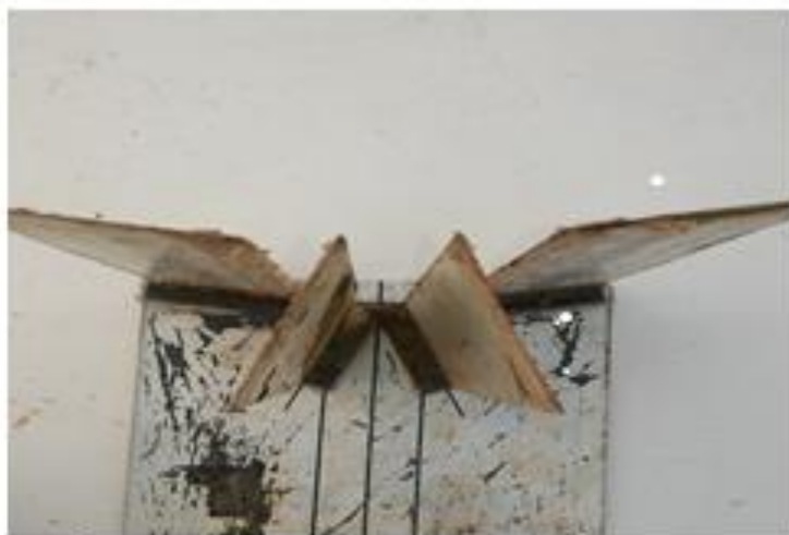
شکل ۲- آرایش شعاعی صفحات مستغرق در آزمایش‌ها.
