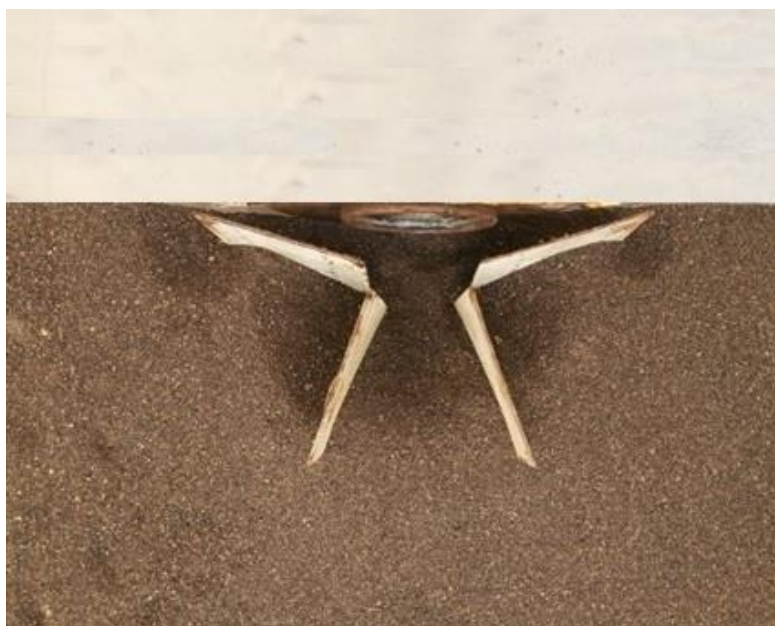
شکل ۱۰- حفره رسوب‌شویی در انتهای آزمایش مربوط به در حالت بهینه آرایش شعاعی.
