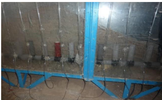
شکل ۳- نحوه نصب رایزرها بر روی لوله افقی و چیدمان ژئوتکستایل (مطبق و لوله ای).
