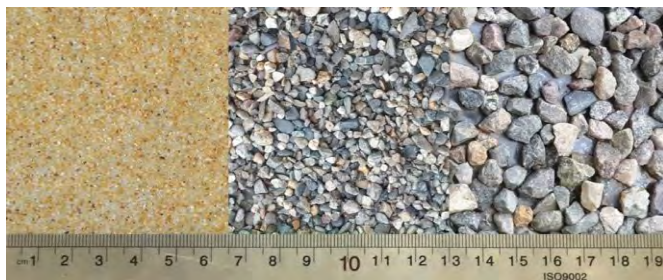
شکل ۲ - نمونه زبری ساخته شده با استفاده از سه نوع مصالح.
