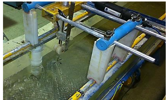
شکل ۵- نمایی از دستگاه ADV و برداشت پروفیل سرعت در اطراف تکیه‌گاه.
