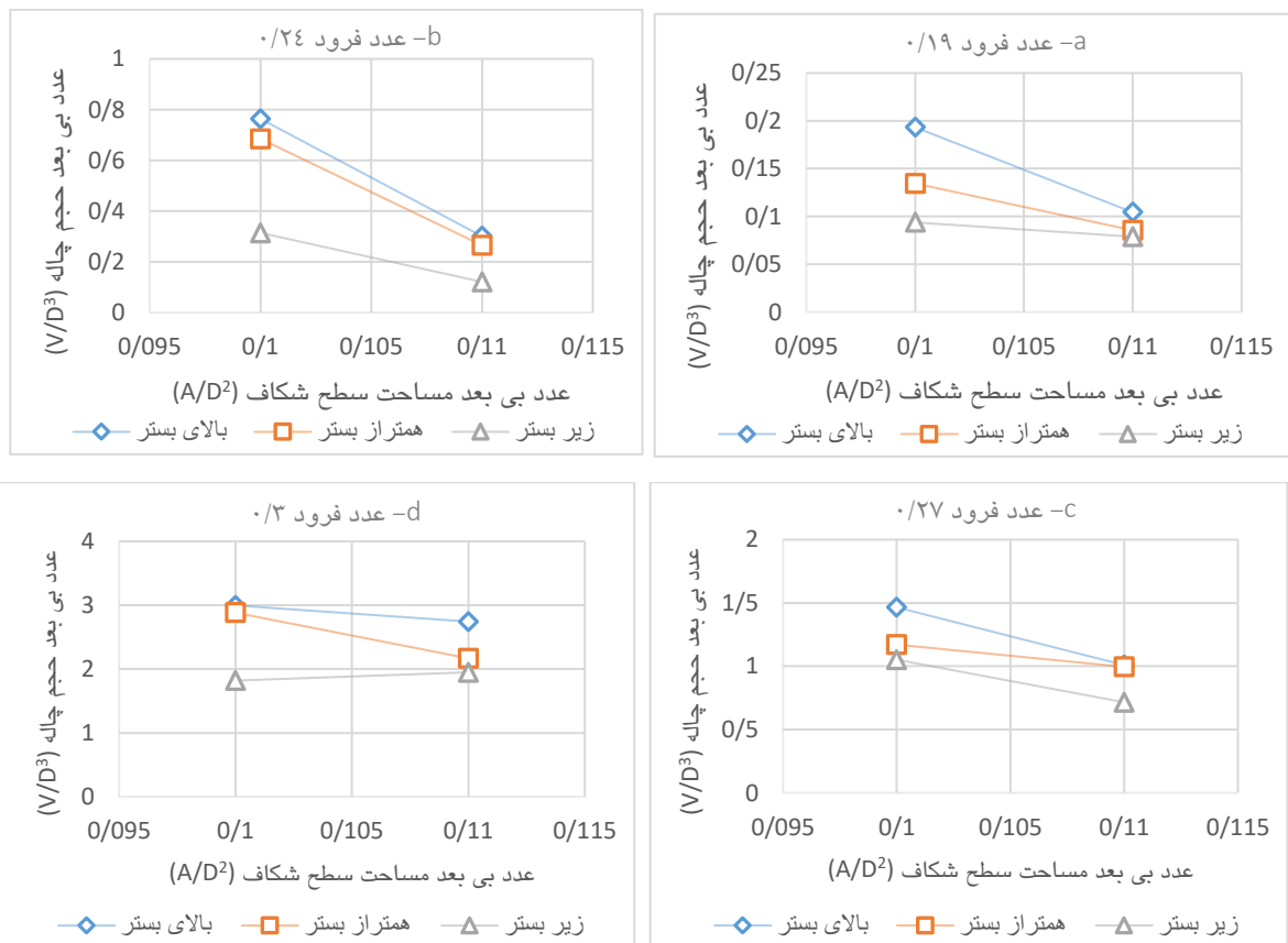
شکل ۱۰ - تأثیر تغییر مساحت سطح شکاف بر حجم چاله‌ی آبشستگی) a- عدد فرود ۰/۱۹، b- عدد فرود ۰/۲۴، c- عدد فرود ۰/۲۷، d- عدد فرود ۰/۳.
