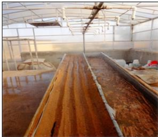
شکل ۱-نمایی از فلوم و شبیه‌ساز باران مورد استفاده در آزمایش.
