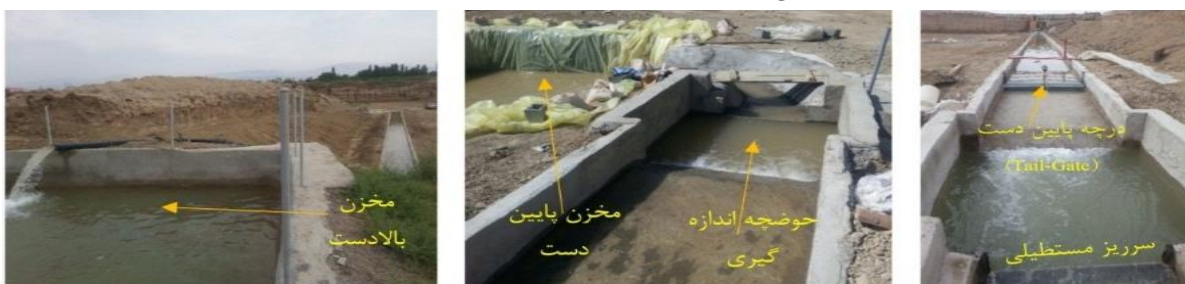
شکل ۳- الف: سرریز مستطیلی و دریچه تنظیمی ( tailgate ) ب- حوضچه اندازه‌گیری و استخر پایین‌دست ج: مخزن بالادست.
