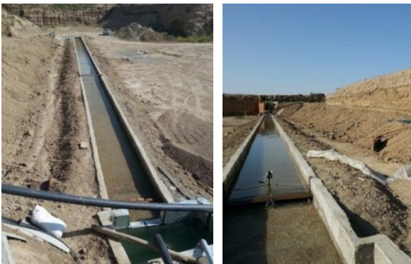
شکل ۱- مدل هیدرولیکی صحرایی کانال عریض
