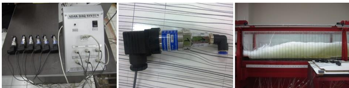
شکل ۲- سنسورهای فشارسنج به همراه سیستم برداشت داده‌ها مربوطه جهت اندازه‌گیری فشار.
