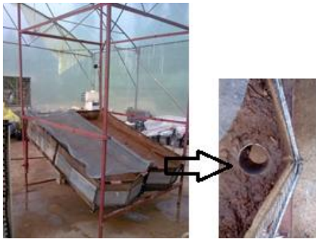
شکل ۱. نمایی از فلوم‌های آزمایشی پس از اعمال باران و خروجی رواناب
