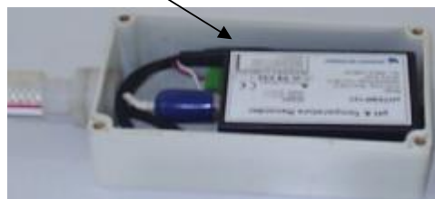
شکل ۱- بخش‌های مختلف سیستم سیار ثبت پیوسته pH شکمبه: الف) سیستم سیار روی بدن گاو؛ ب) الکترود pH متر همراه با اتصالات؛ ج) رابط اتصال وزنه به الکترود؛ د) وزنه استیل؛ ه) الکترود pH متر؛ و) شیلنگ محافظ کابل الکترود؛ ز) دستگاه ثبت داده؛ ح) جعبه محافظ دستگاه ثبت داده؛ ط) کمربند.
