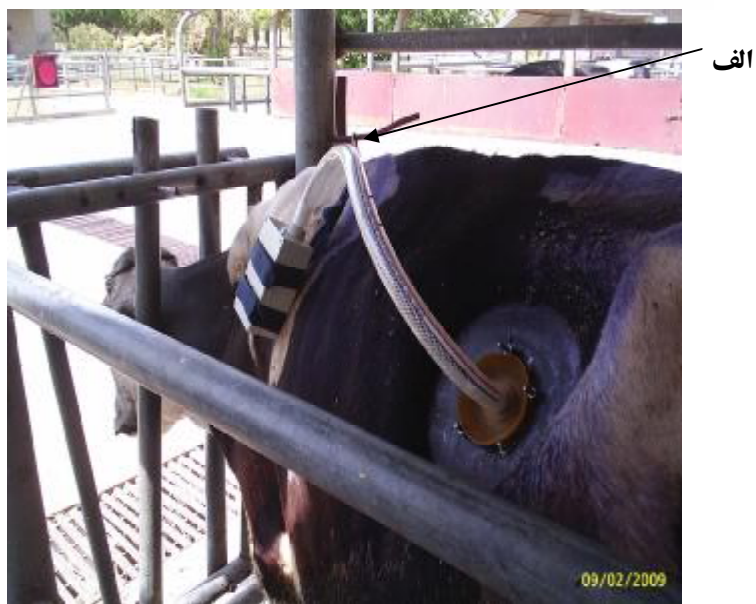
شکل ۱- بخش‌های مختلف سیستم سیار ثبت پیوسته pH شکمبه: الف) سیستم سیار روی بدن گاو؛ ب) الکترود pH متر همراه با اتصالات؛ ج) رابط اتصال وزنه به الکترود؛ د) وزنه استیل؛ ه) الکترود pH متر؛ و) شیلنگ محافظ کابل الکترود؛ ز) دستگاه ثبت داده؛ ح) جعبه محافظ دستگاه ثبت داده؛ ط) کمربند.
