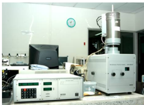
شکل ۱- دستگاه STA جهت اندازه گیری ویژگی های حرارتی مواد مختلف.
