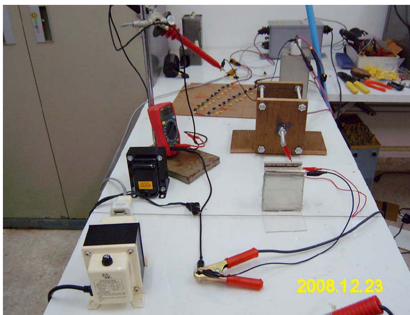
شکل ۱- سیستم اعمال میدان الکتریکی پالسی قوی 3\text{ kV } 8\text{ }\mu\text{F}
