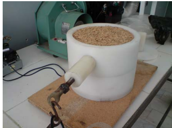
شکل ۳- الف) دستگاه سلول برش برای اندازه‌گیری زاویه اصطکاک داخلی و ب) شماتیک مقطع و اجزای آن
