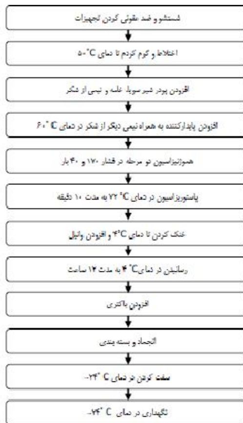
شکل 1- فرآیند تولید بستنی سین‌بیوتیک سویا
