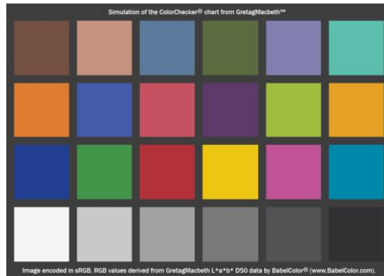
شکل ۳- تصویری از صفحه رنگی یا Color-checker مورد استفاده در مقایسه بین سیستم‌های اندازه‌گیری پارامترهای Lab
