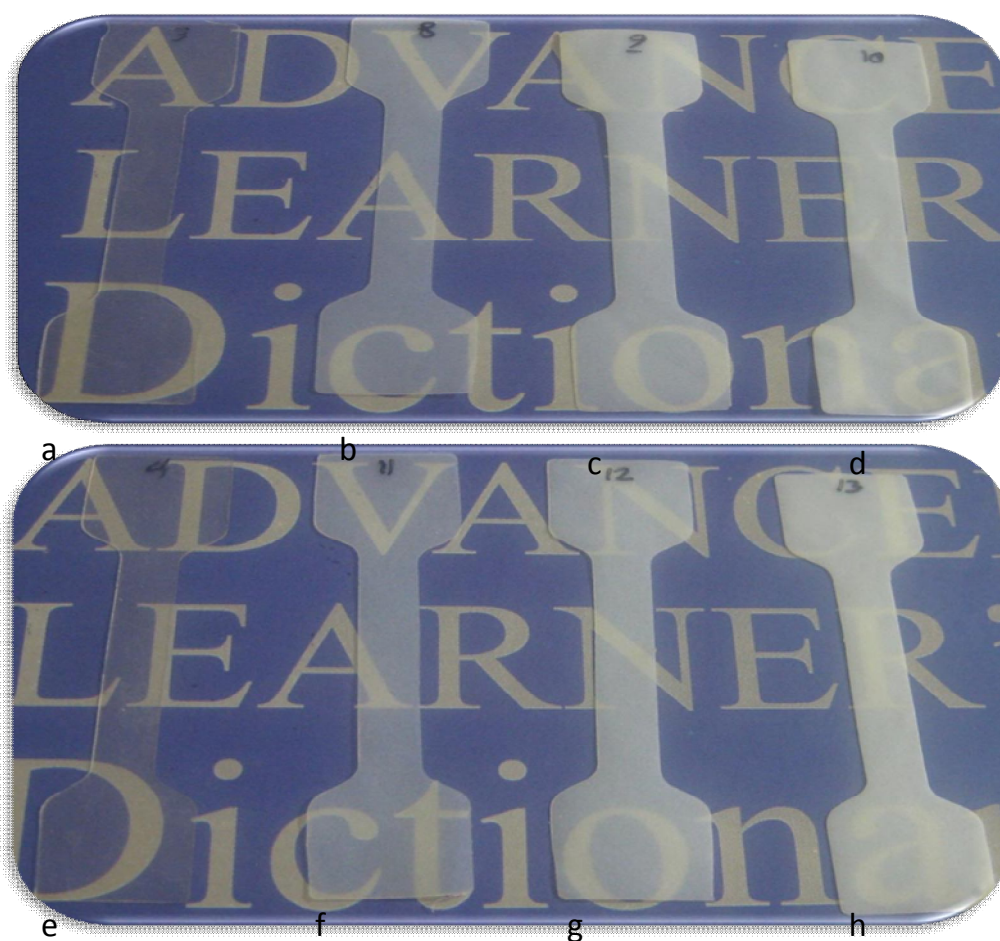
شکل ۵- ظاهر فیلم‌های زیست‌نانوکامپوزیتی نشاسته‌ای حاوی مخلوط نانوذرات MMT و \text{TiO}_2 : (a) PS-3%MMT: \text{TiO}_2 و (b) PS- 3%MMT-0.5% \text{TiO}_2 ؛ (c) PS-3%MMT-1% \text{TiO}_2 ؛ (d) PS-3%MMT-2% \text{TiO}_2 ؛ (e) PS-5%MMT؛ (f) PS-5%MMT-0.5% \text{TiO}_2 ؛ (g) PS-5%MMT-1% \text{TiO}_2 و (h) PS-5%MMT-2% \text{TiO}_2 .
