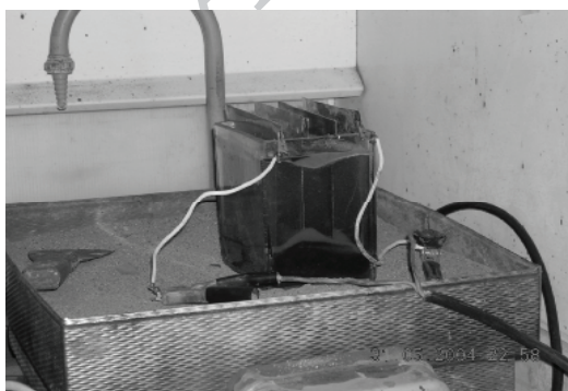
شکل ۴: راکتور الکتروشیمیایی در حال حذف سیانید از پساب آبکاری
