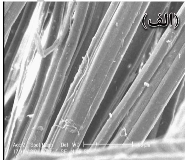
شکل ۲: (الف) تصاویر میکروسکوپ الکترونی روبشی الیاف گونی (ب) الیاف گونی پس از تثبیت
