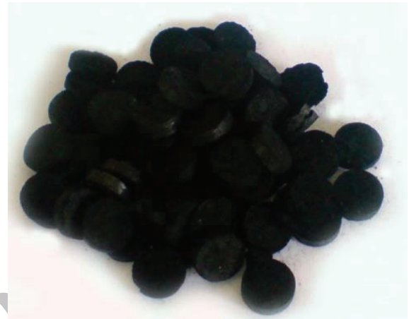
شکل ۱ تصویر نانولوله‌های کربنی شکل‌دهی شده
