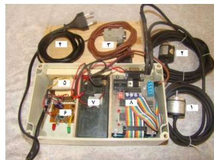
1- چرخش سنج چرخ ستاره‌ای 2- چرخش سنج چرخ پنجم 3- درگاه سریال RS 232 4- ورودی برق به شارژر 5- ترانسفورماتور کاهنده 6- مبدل جریان متناوب به مستقیم 7- باتری 8- صفحه شبکه کننده داده‌ها
