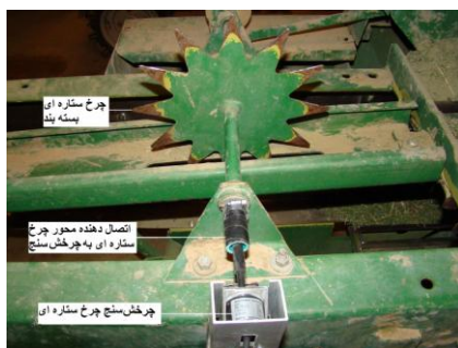
شکل 2- چرخش سنج چرخ ستاره‌ای و اتصال آن به محور چرخ ستاره‌ای
