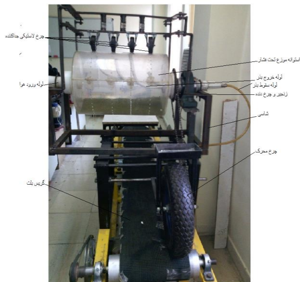
شکل ۱. موزع استوانه‌ای تحت فشار مجهز به جداکننده مکانیکی بذر (چرخ لاستیکی جداکننده)
