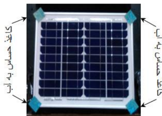
شکل ۴. پنل خورشیدی در شرایط تشکیل شبنم همراه با نصب کاغذ حساس به آب.
