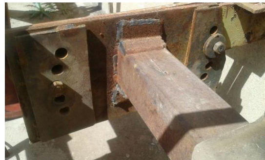
شکل ۳. مکانیزم تغییر زاویه حمله
