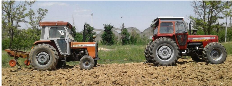
شکل ۴. آزمون دو تراکتوری (تست RNAM)
